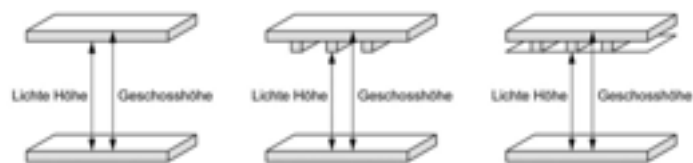
Abbildung 30: Skizzen zur lichten Höhe (Quelle: Integration der harmonisierten Baubegriffe und Messweisen in die Bau- und Nutzungsordnung; Empfehlung; Departement Bau, Verkehr und Umwelt, Stand August 2011)
